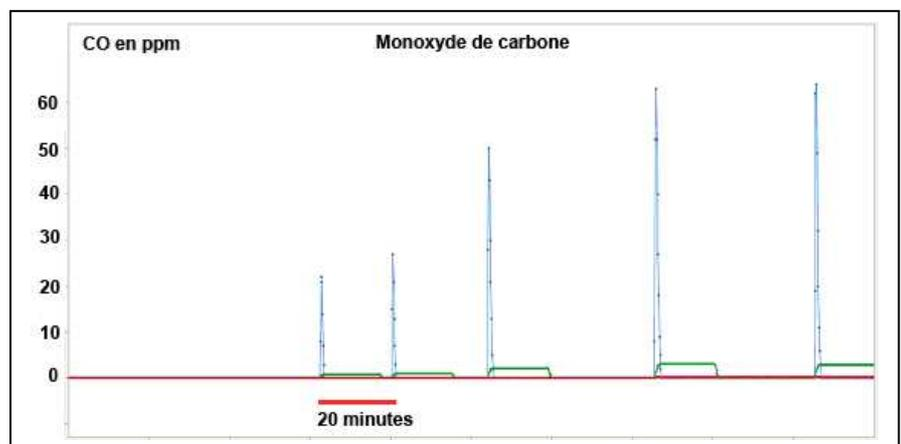
En fin de séance, nous avons réalisé un test avec l'utilisation d'une charge type « poudre » pour mesurer les taux de CO et CO<sub>2</sub>. Ceux ci se sont révélés non négligeables et des essais complémentaires seront à programmer en 2012
